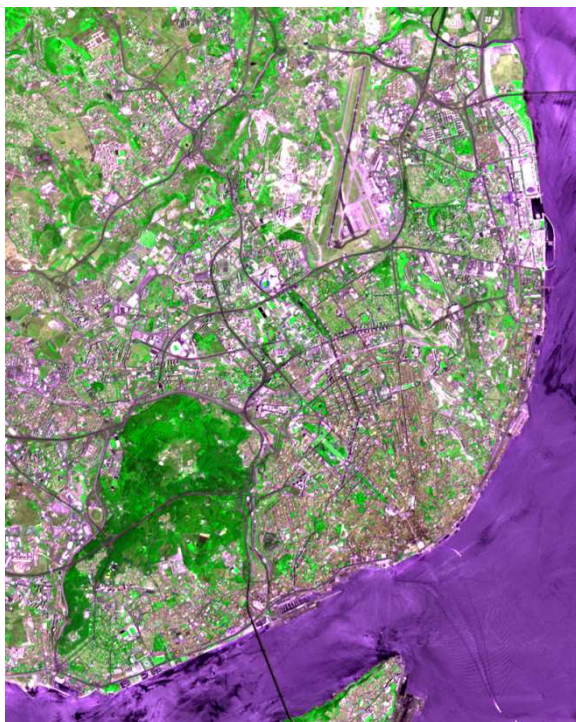
Figura 1: Composição colorida R2G3B1 dos dados VNIR do sensor ASTER de 26 de junho de 2004 da área de estudos.
