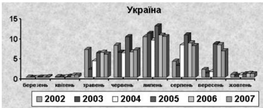
Рис. 5. Диаграмма зависимости Kveg от времени в вегетационный период в Украине за 2002-2007 года
