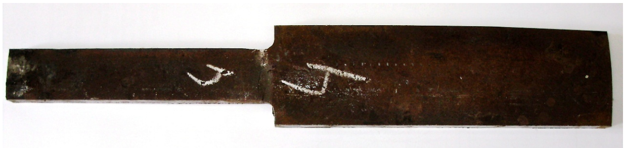
Рисунок 7.7 – Загальний вигляд зразка для випробувань на втомну міцність
