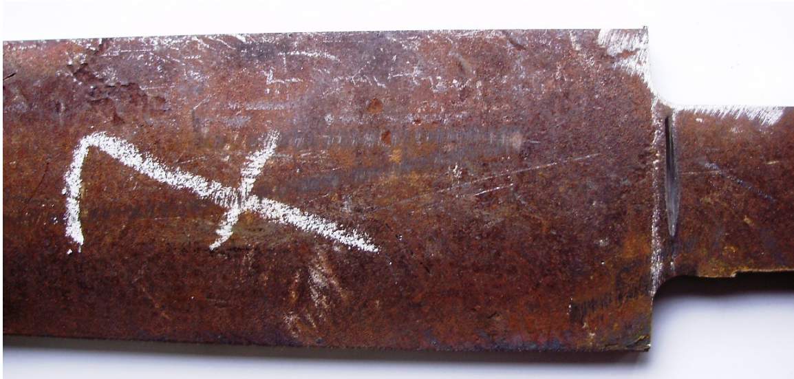
Рисунок 7.9 – Зразок з концентратором
