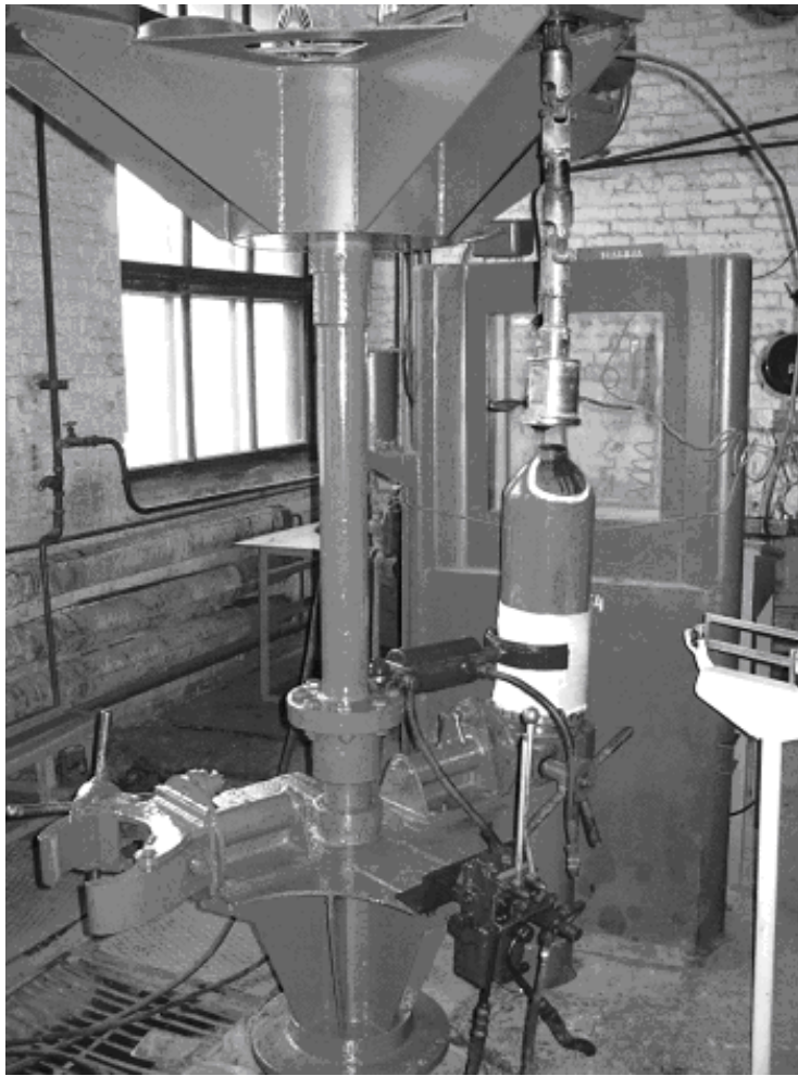
Рисунок 9.16 - Стенд для випробовування балона з намотаним полімерно-композитним бандажем
