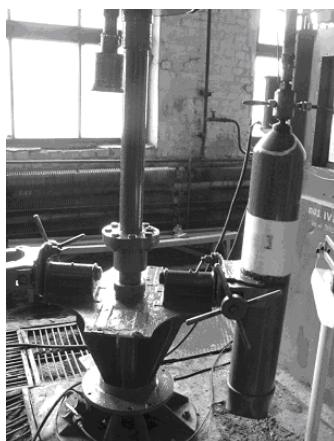
Рисунок 9.14 – Стенд гідравлічного випробування
