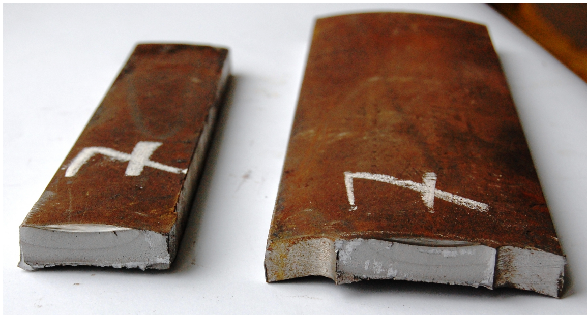
Рисунок 7.10 – Злом моделі-вирізки з концентратором
