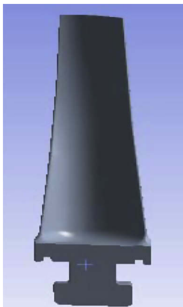
Fig. 1. Simple 'T'-root LP blade.
