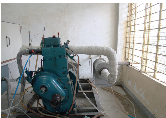
FIGURE 2: Dual fuel arrangement OBRÁZEK 2: Uspořádání pro přívod dvou paliv
