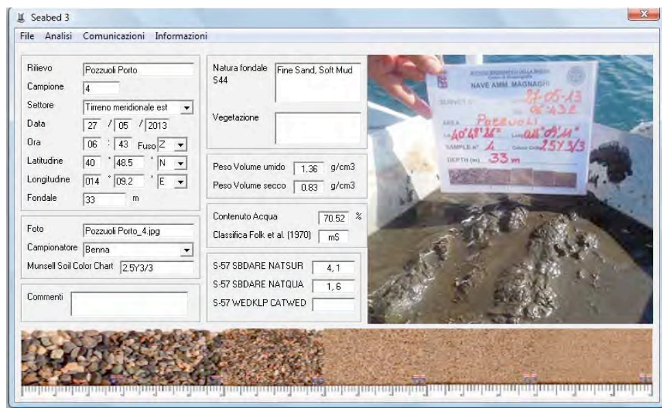
Figura 32. Carota B7N (a sinistra) ed esempio classificazione sedimento da software seabed (a destra).
