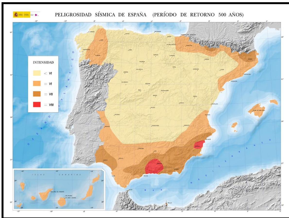
Figura 4. Mapa de Peligrosidad Sísmica en España para un periodo de recurrencia de 500 años. Fuente: IGN.
