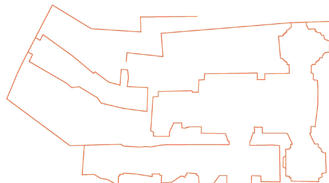
Figura 6. Trazado vectorial de la planta obtenido a partir de la nube de puntos. (Elaboración propia).
