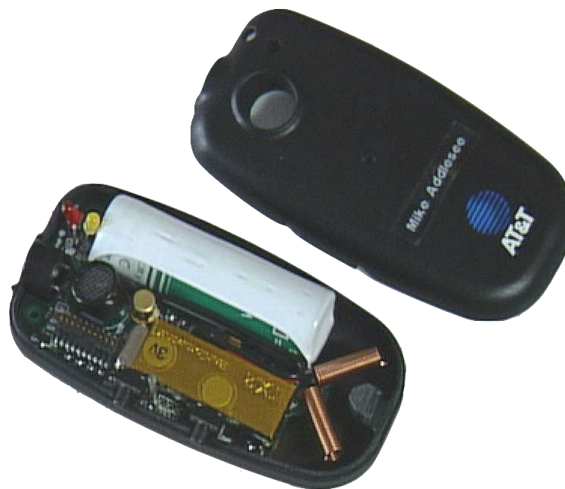
FIGURA 1.2: Módulo emisor en The Active Bat System
