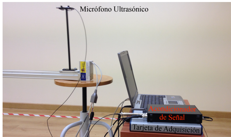
FIGURA 5.22: Montaje para la adquisición con el micrófono ultrasónico sobre el slider .
