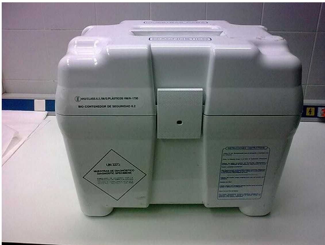
Fig. 9: Contenedor refrigerado con control de interrupción de cadena de frío.
