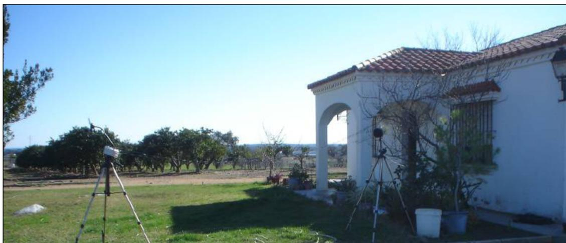
Ilustración 27. Ejemplo de instalación de sonómetro y estación meteorológica
