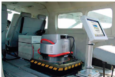
Figura 91. Cámara Leica ADS40. (fuente: Leica Geosystems)
