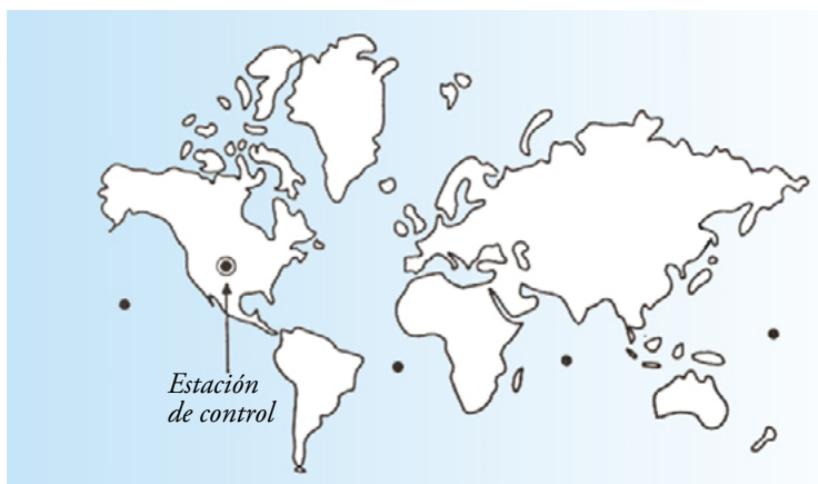
Figura 23. Disposición inicial de las estaciones WGS84.
