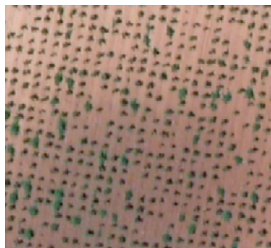
Figura 147. Arrastres de la imagen en la ortofoto por error del MDE.
