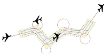
Figura 150. Proyecto de vuelo de una traza lineal.
