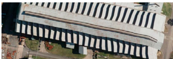
Figura 148. Deformaciones por errores del MDE.
