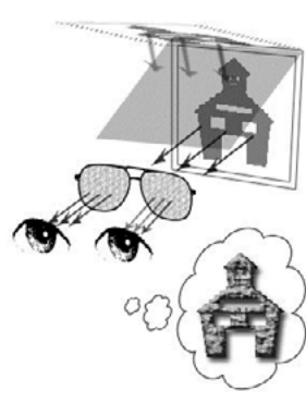
Figura 52. Estereoscopia por polarización con dos pantallas.
