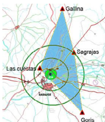
Figura 26. Ejemplo de toma de datos para la transformación WGS84-ED50.
