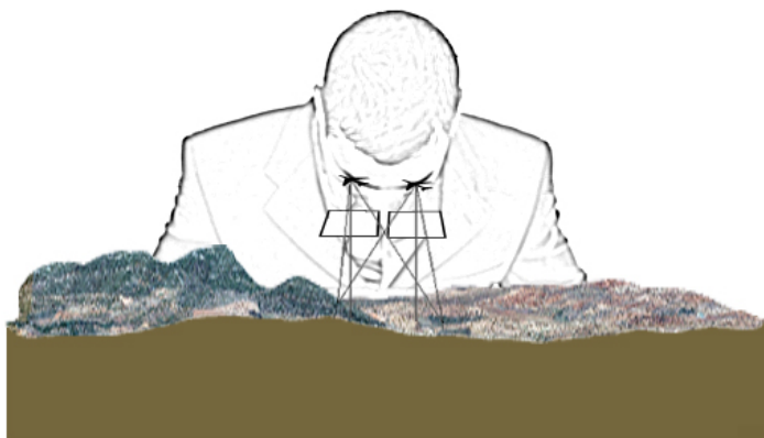
Figura 49. Principio estereoscópico de la fotogrametría.
