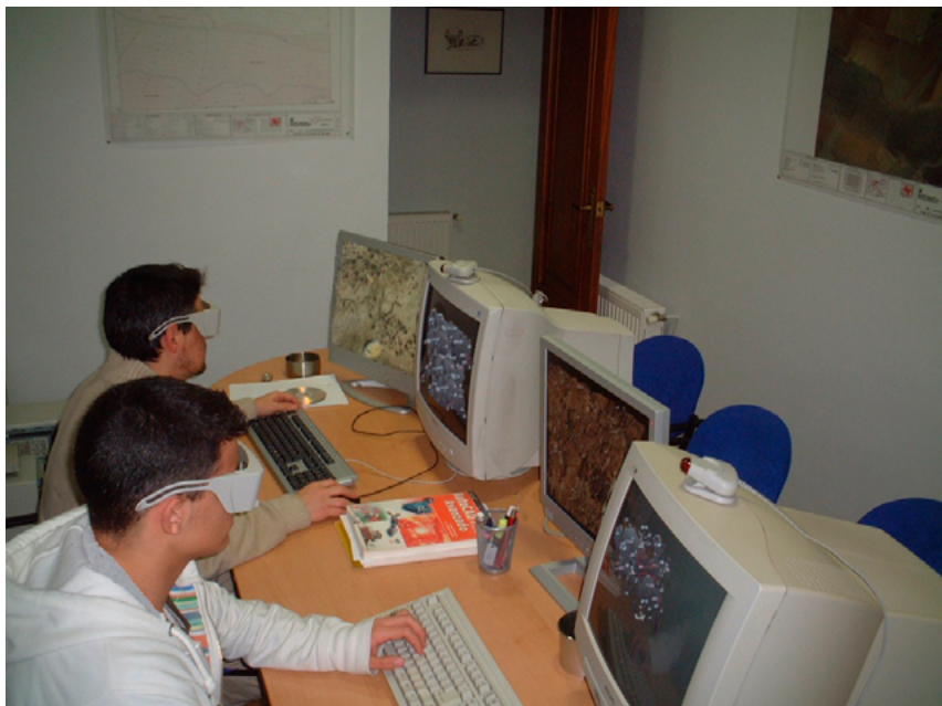
Figura 54. Estereoscopia por separación temporal
