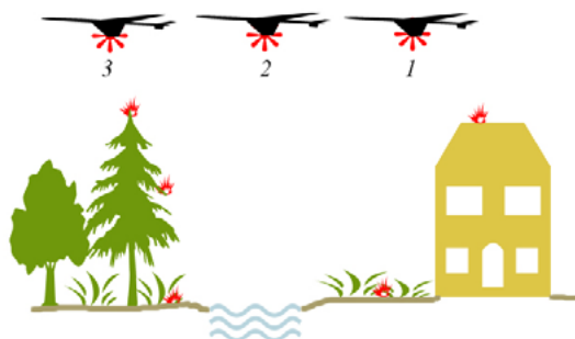
Figura 160. Funcionamiento del LiDAR ante distintas superficies.
