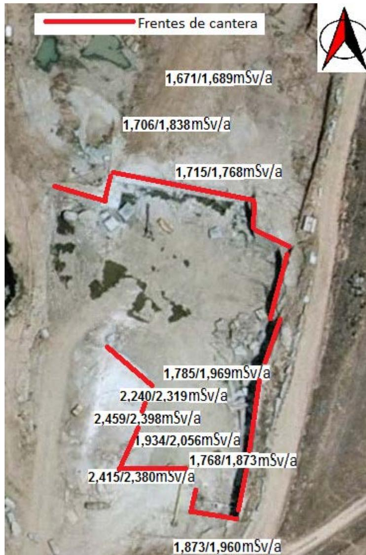
Figura 4.2: Medidas de irradiación externa efectuadas en la zona de cantera (invierno/verano).
