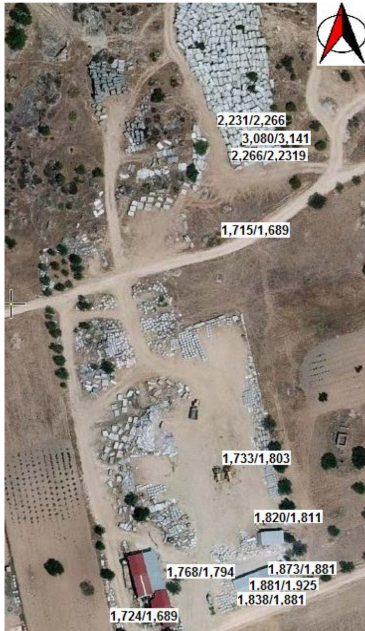
Figura 4.4: Niveles de irradiación externa medida (mSv/a) en la zona del taller de labra manual (invierno/verano).
