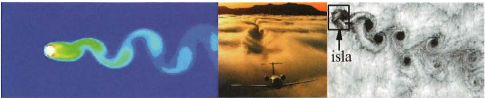
Vórtices de Von Kármán tras un cilindro de 1 mm de diámetro ( www.cps.unizar.es ), un avión ( egyptian-cream.livejournal.com ), y la isla de Juan Fernández en el Océano Pacífico [3]. El mismo fenómeno en escalas muy diferentes.
