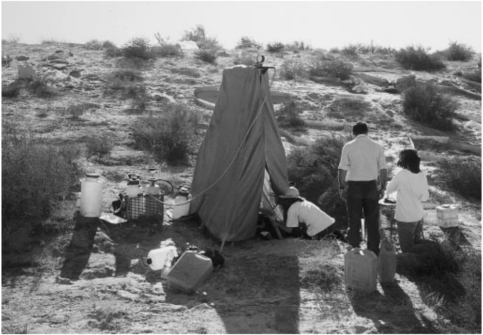
Figura 3: Vista del simulador de lluvia durante uno de los experimentos sobre un suelo vegetado, VGI.
