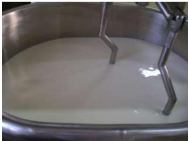
Figura III.12. Calentamiento de la leche y homogeneización en la cuba.
