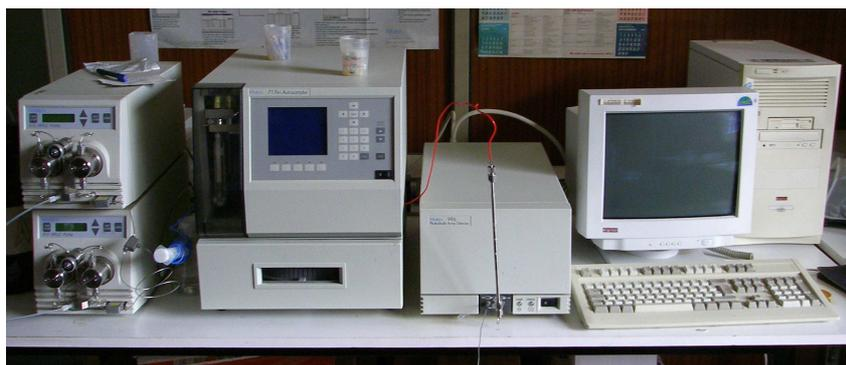
**Figura 1:** Cromatógrafo líquido de alta presión, HPLC, usado para la separación y análisis de las distintas muestras.
