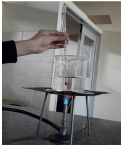
Figura 22. Medición de la temperatura del agua en un beaker sobre un mechero.
