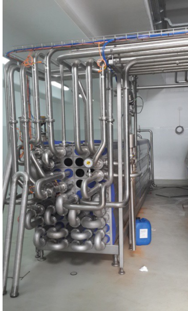
Figura 24: Esterilizador Aseptic Flex tetra pak de 2000 litros/hora
