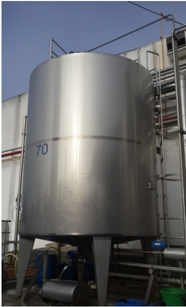
Figura 23: Tanque de almacenamiento de 10.000 litros
