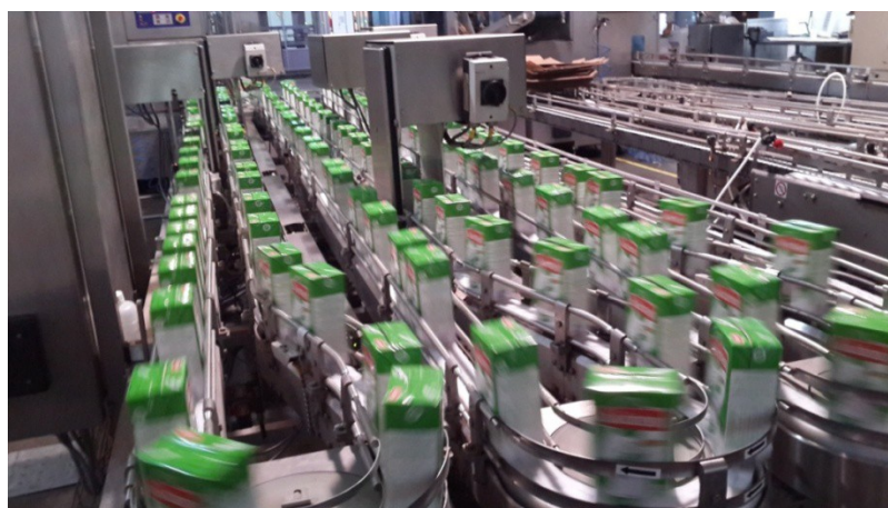
Figura 14: Cinta transportadora de envases tetra brik® de un litro de leche UAT hacia las máquinas emparadoras
