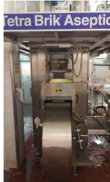
Figura 22: Envasadora Marca Tetra Pak®, modelo TBA-6 de 2000 litros/hora
