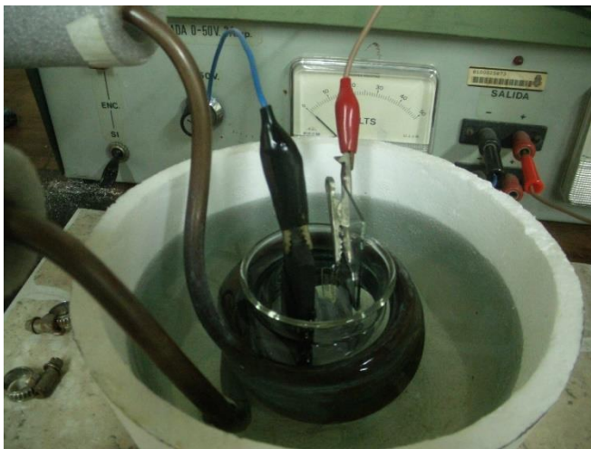
Figura 3.4. Sistema de anodizado. Conectado al terminal negro se observa el bloque de grafito de alta densidad y conectado al rojo, la lámina de aluminio. Ambos elementos están sumergidos en un baño térmico. Detrás se encuentra la fuente de tensión continua.
