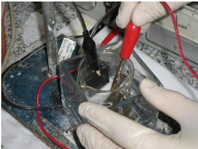
Figura 3.2. Proceso de electro-pulido. Conectado al terminal negro se observa el bloque de grafito de alta densidad y conectado al rojo, la lámina de aluminio. Ambos elementos están conectados a una fuente de tensión continua.
