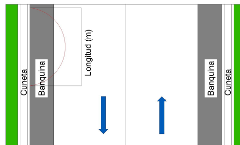
Imagen N° 6 - Fisura en medialuna (FML, Unidad de medida: m2, Penalidad: m2-carril)
