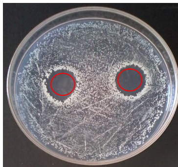
Figura 2. Ensayo de difusión en medio de cultivo para superficies de BOPPP-g-AA + NAT.
