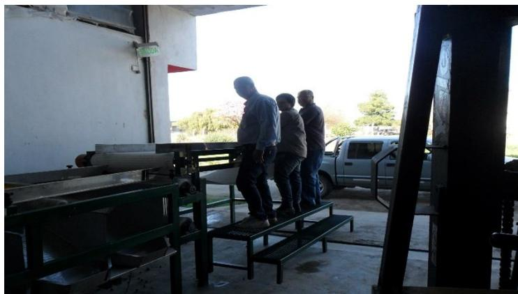
Foto 4: Vista lateral del módulo de clasificación con uno de los palcos de trabajo para los operarios.
