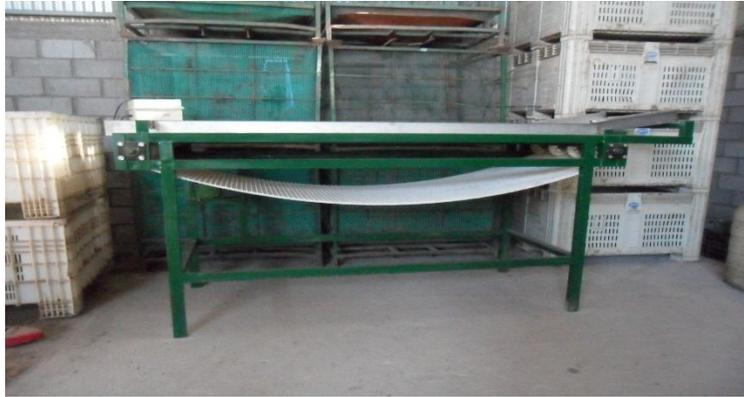
Foto 2: Módulo clasificador con el variador de velocidad en el box blanco que se observa en la parte superior izquierda.
