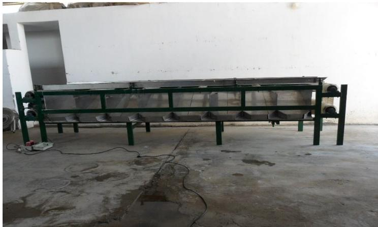
Foto 3: Módulo tamañador de 8 clases de fruto con el variador de velocidad en el ángulo inferior izquierdo
