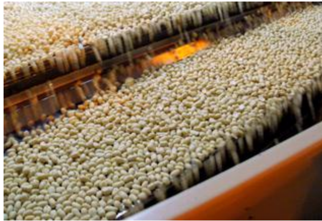
Figura 5.8 Maní Blanchado Inspección (tomado de http://www.gastaldihnos.com.ar/producto-proceso-mani.html )
