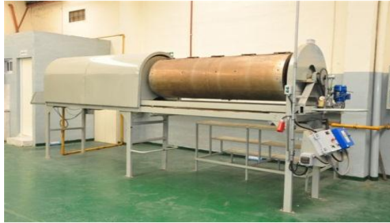
Figura 9.1. Horno Rotativo de Temperatura Controlada. (Tomado de www.soarg.com.ar )
