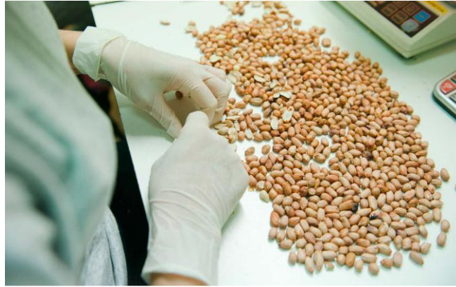
Figura 5.5 Operación de Inspección (tomado de http://www.gastaldihnos.com.ar/producto-proceso-mani.html )
