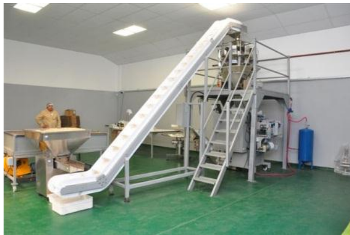
Figura 5.10 Línea de Envasado (tomada de http://www.soarg.com.ar/planta.php )
