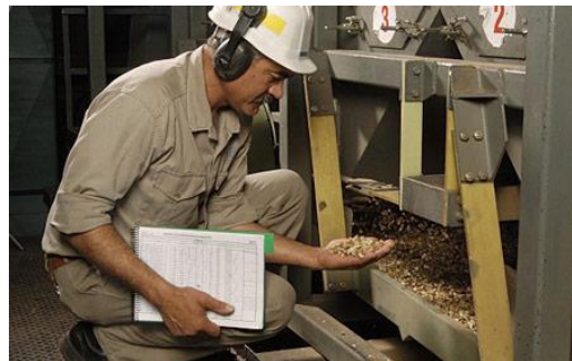
Figura 5.2 Control de descascarado (tomado de http://www.gastaldihnos.com.ar/producto-proceso-mani.html )
