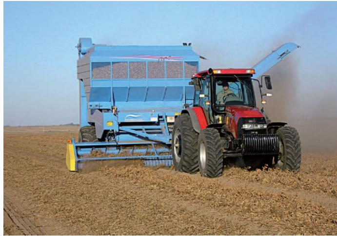
Figura 4.3 Descapotadora de doble hilera (tomado de http://www.ciacabrera.com.ar/docs/Mani,%20Guia%20practica%20para%20su%20Cultivo.pdf )
