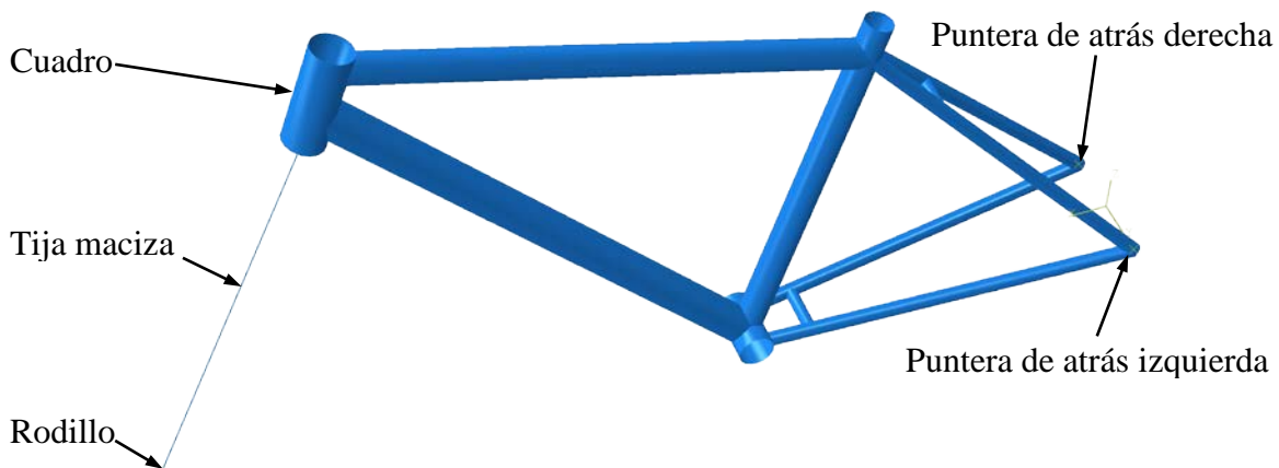
Figura 4.2-9: Ensamble del conjunto cuadro-tija en la configuración de ensayo.
