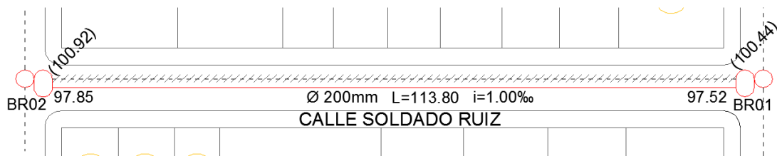
Figura 3.72: Extracto del Plano Conforme a Obra
