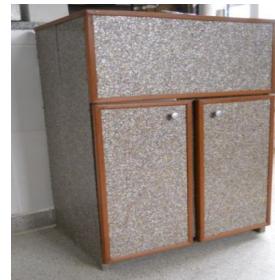
Figura 4. a) Láminas que se reciclan para la elaboración de tableros aglomerados. b) Tableros aglomerados con plásticos reciclados. c) Prototipo de mueble para bajo mesada de baño.
