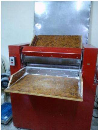
Laminadora: mediante rolos de metal esta máquina toma las escamas y mediante un proceso de laminado y presión, va dando consistencia a la masa. Se hacen varias pasadas de la misma masa que permiten aglutinar los ingredientes y formar una lámina homogénea y de poco espesor. La medida de capacidad de esta máquina se mide en centímetros del ancho de la lámina que es de 60 centímetros.
