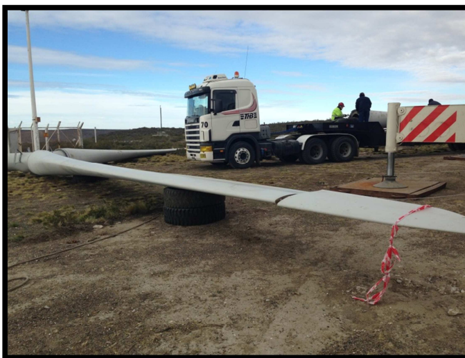
Fotografía 2.5: vista de aspas con punta variable
