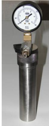
**Figura 2.** Dispositivo para extracción de saponinas de quinoa a alta presión
