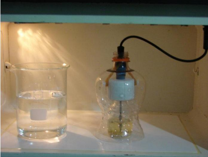
**Figura 1.** Dispositivo para la extracción de saponinas en microondas.
