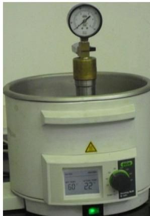
**Figura 3.** Dispositivo de extracción en baño termostático
