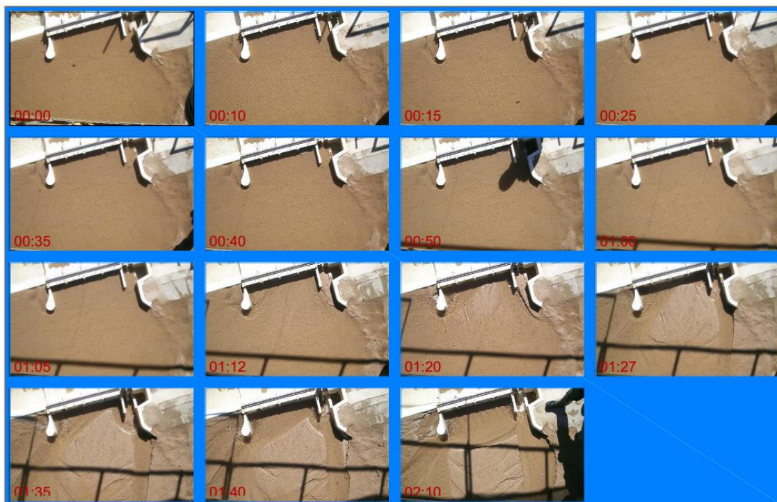
Figura 111: Secuencia de imágenes de la fosa de erosión tomadas desde un punto fijo. Tiempos en modelo para el Ensayo 31.
