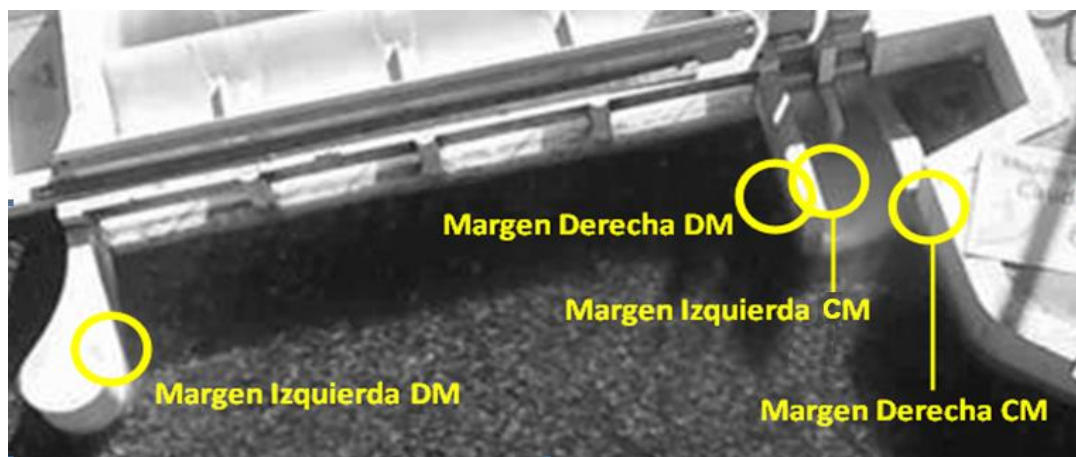
Figura 47: Localización de las escalas donde se midió la cota del pelo de agua durante el ensayo.
