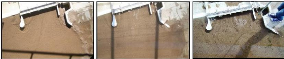
Etapa 4 - Tiempo 40min: DM 50% abierto, CM 100% abierto, Q = 225m 3 /s
