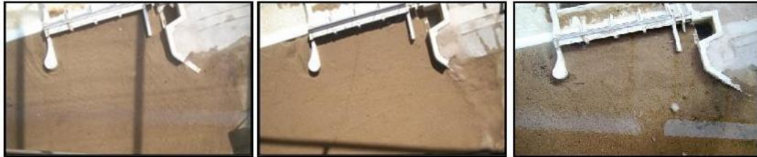
Etapa 3 - Tiempo 30min: DM 20% abierto, Q = 250m 3 /s
