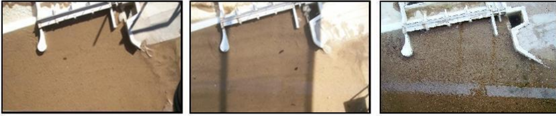
Etapa 2 - Tiempo 20min: DM 10% abierto, Q = 400m 3 /s
