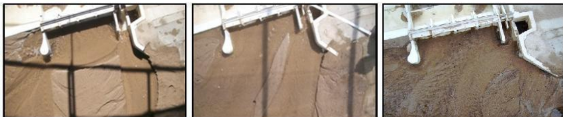
Etapa 4 - Tiempo 40min: DM 50% abierto, CM 100% abierto, Q = 225m 3 /s
