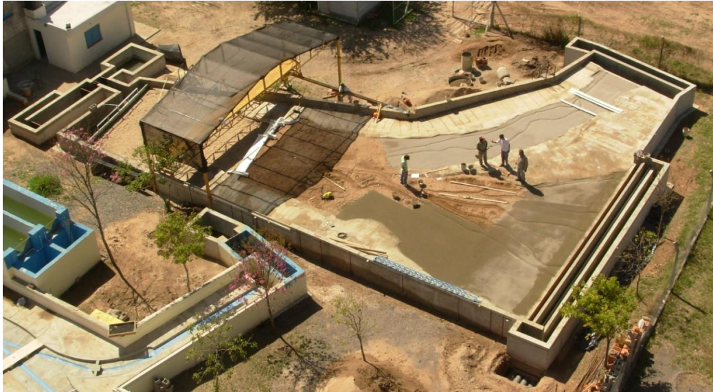
Figura 25: Modelo Físico del Dique Los Molinos construido en el Laboratorio de Hidráulica de la Universidad Nacional de Córdoba.
