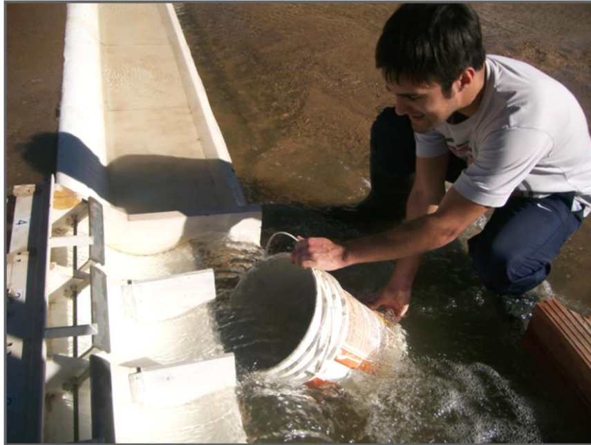
Figura 33: Medición Volumétrica del caudal evacuado en el Dique Móvil 3.
