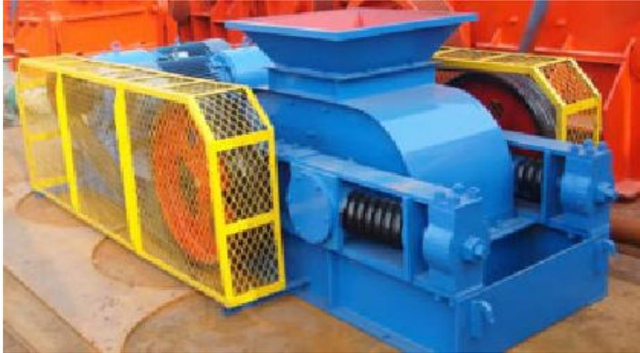
Figura 34. Molino de rodillos modelo 2PG700-400 – Henan
