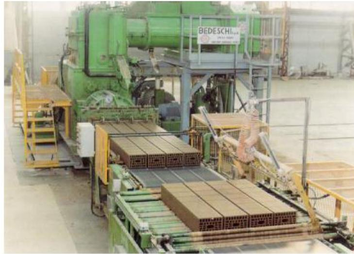
Figura 31. Extrusora para moldeo con molde intercambiable.
