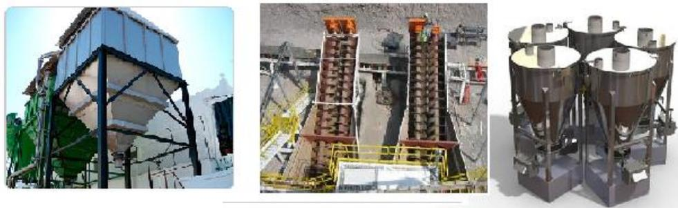
Figura 26. Tolva vibradora, tornillo sin fin, alimentador estrella (respectivamente)
