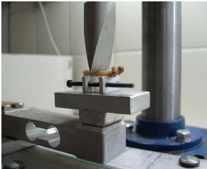
Figura 30: Ensayo de flexión a tres puntos
