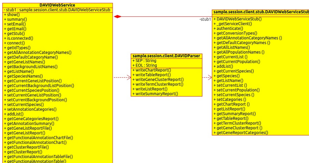
Figura 3.10: Diagrama de clases del módulo de conectividad entre R y Java. DAVIDWebService utiliza el paquete rJava para acceder/controlar el servicio web de DAVID a través de la clase DAVIDWebServiceStub y decodificar los reportes hacia R mediante la clase DAVIDParser . Note que por simplicidad se han omitido las firmas de las funciones. Imágenes extraídas de Fresno y Fernández (2013c).
