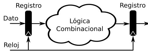
Figura 4.1: Circuito digital síncrono básico.
