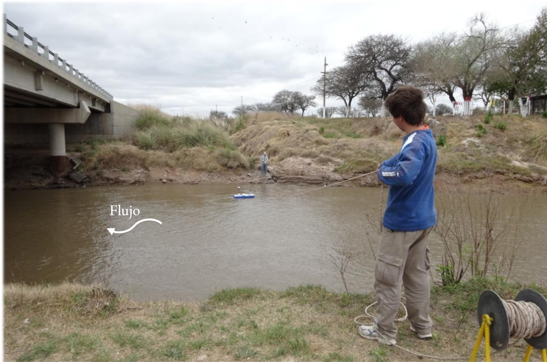
Figura 3.18 - Sección de aforo en el río Saladillo ubicada en el cruce con la ruta provincial 6.
