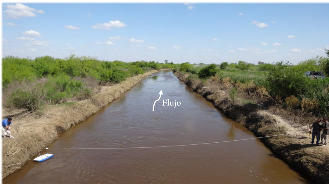
Figura 3.36 - Sección de aforo en el arroyo Tortugas ubicada en proximidades de la localidad homónima.
