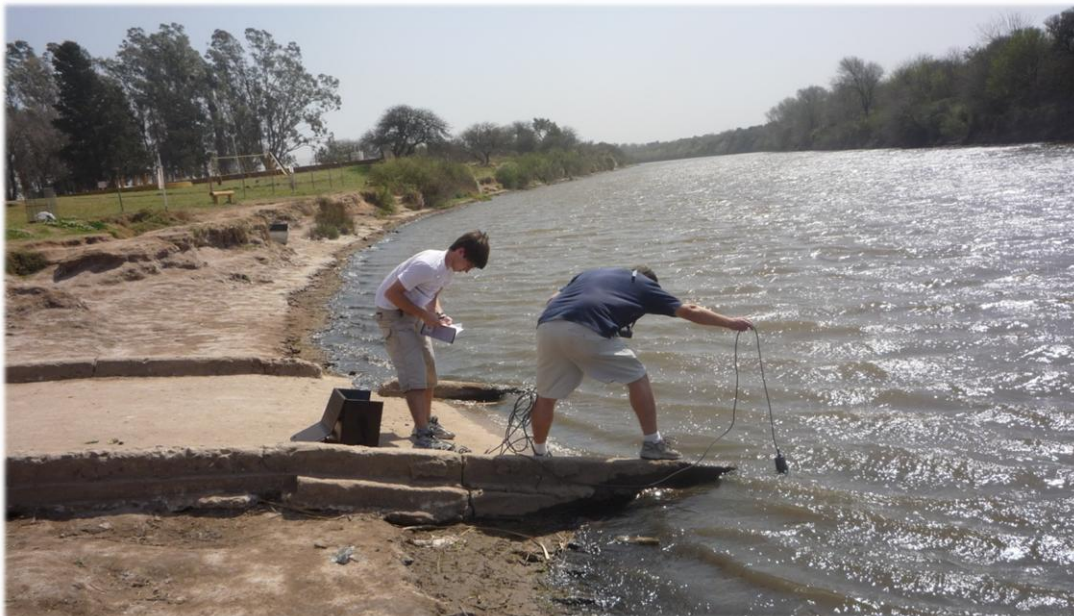
Figura 3.37 - Determinación de temperatura y conductividad utilizando una sonda multiparamétrica marca Horiba modelo U-10.
