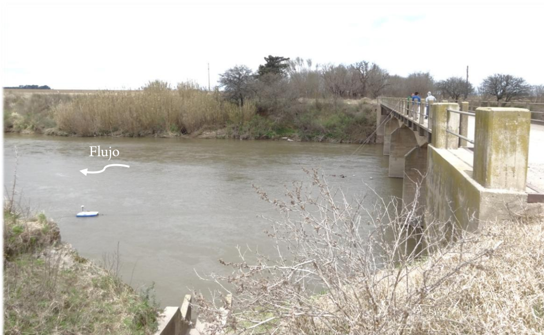
Figura 3.24 - Sección de aforo sobre el río Carcarañá ubicada a 11,5km aguas abajo de la confluencia en cercanías de la localidad de Inrville.
