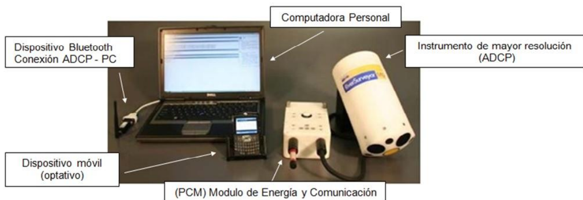
Figura 2.3 - Elementos necesarios para el correcto funcionamiento del ADCP.
