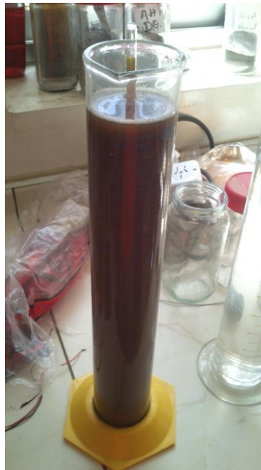
Figura 4.51 - Probeta con solución de suelo, agua y defloculante, y el hidrómetro en su interior.
