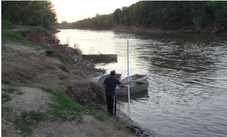
Figura 4.44 - Lecturas con nivel y mira telescópica, en río Carcarañá - sección Parque Sarmiento (Carcarañá).
