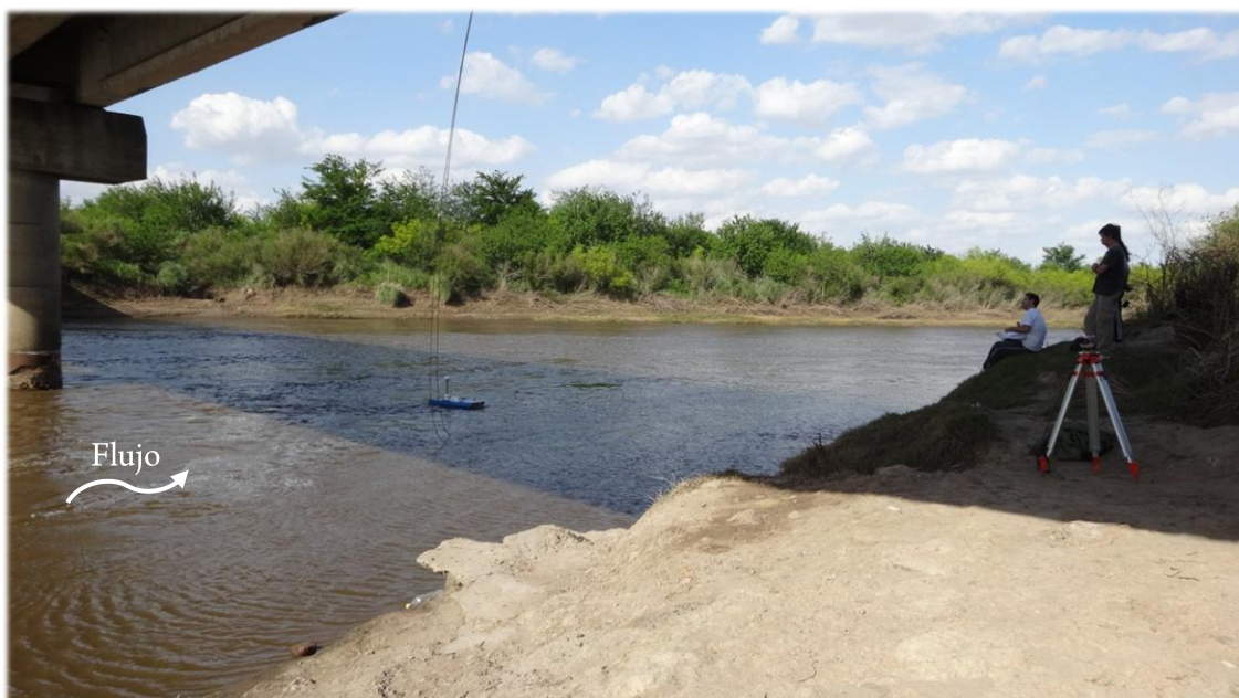
Figura 3.28 - Sección de aforo en el río Carcarañá ubicada en el cruce con la ruta provincial 15 (Santa Fe) en proximidades de la localidad de Cruz Alta.
