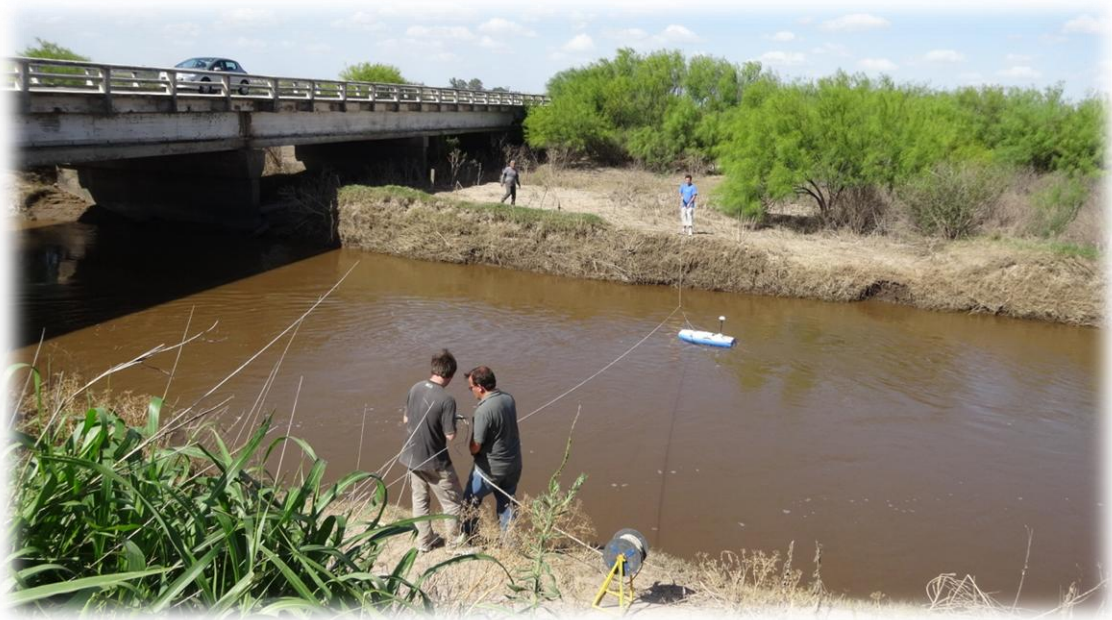
Figura 3.2 - Medición de velocidades de flujo y caudales remolcando la embarcación desde las márgenes.
