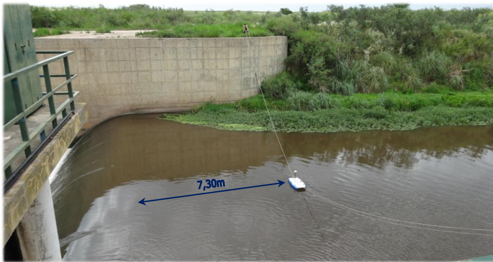
Figura 3.44 - Distancia entre la trayectoria del ADCP y el azud.
