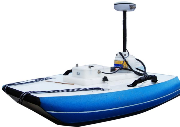
Figura 2.6 - Barco de medición con todos los dispositivos instalados (YSI/Sontek).
