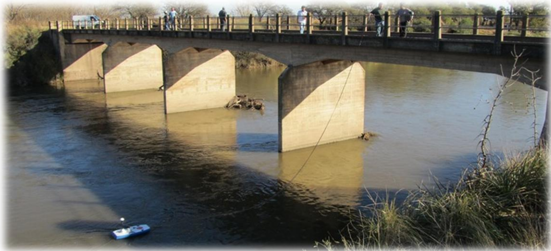
Figura 3.3 - Medición de velocidades de flujo y caudales remolcando la embarcación desde un puente.
