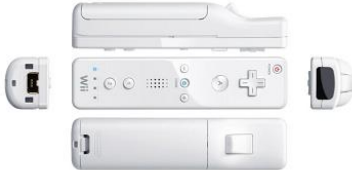
Figura 6.11 Diferentes vistas del wiimote. En la imagen de la derecha se puede ver la cámara del dispositivo.
