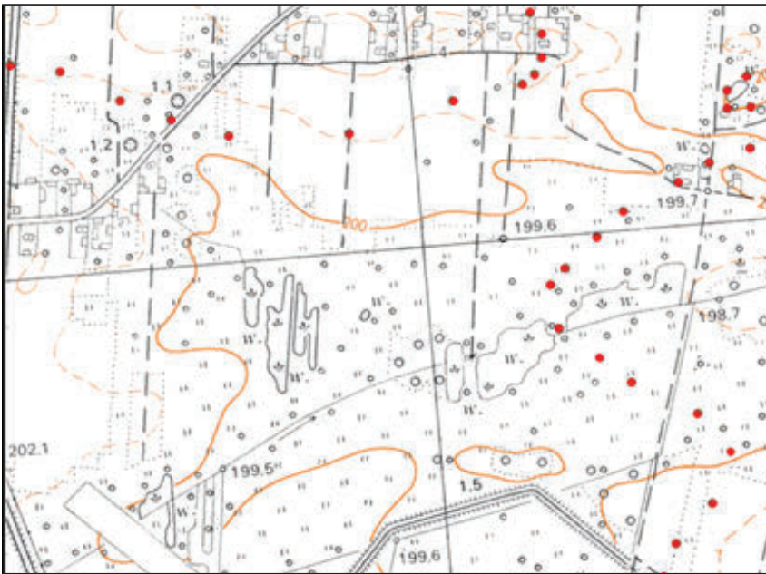
Rys. 2. Przebieg wektoryzowanej poziomicy 200 m n.p.m. z mapy w skali 1:25 000 (oznaczono kropkami) na tle mapy w skali 1:10 000 (Arkusz 132.411 Wola Grzymalina)
