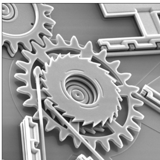
Rys. 50. Mechanizm zapadkowy wykonany z amorficznego krzemu (zdjęcie pochodzi ze strony www.mems.sandia.gov )
