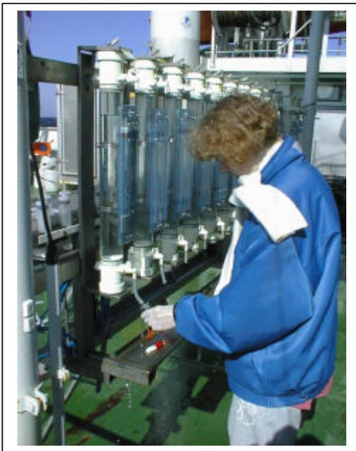
**Bild 2.1:** Die Wasserproben werden nach der Probenahme mit Nansen Wasserschöpfern für die Laboruntersuchungen abgefüllt (Fotografie A.O. LAINE, Forschungsschiff Aranda).
