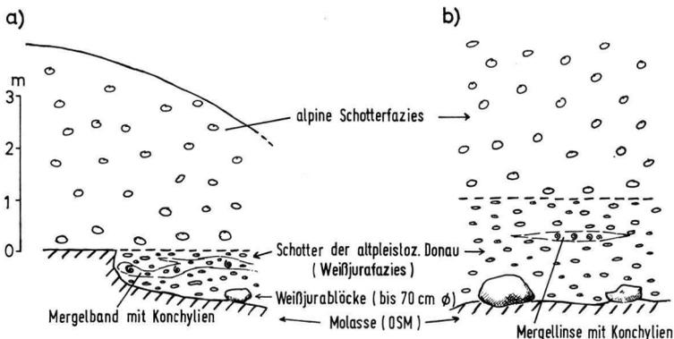
Abb. 9: Die molluskenführenden Aufschlüsse am Brennborg (2,5 km SW Burgau; RW 3602450/HW 5365280) und am Kirchberg (1 km E Wörleschwang; RW 4397260/HW 5367950). Entwurf M. Löscher.
