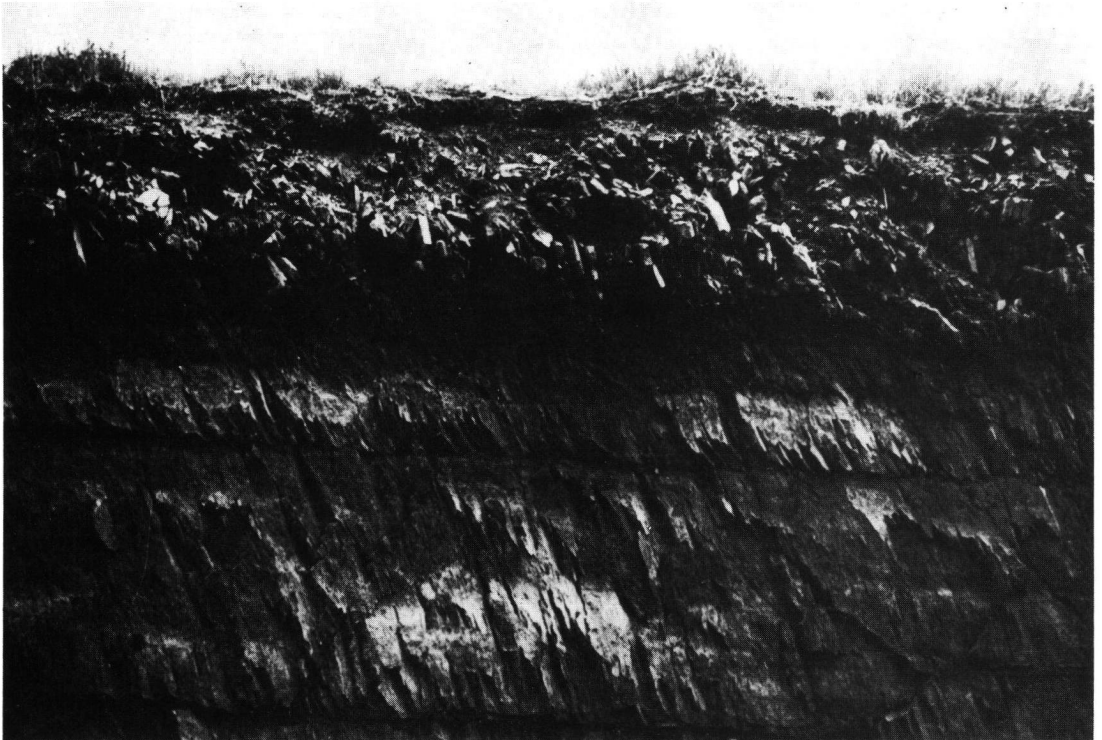
Abb. 10: Profil „Altekülz“ — Braunerde in Frostschutt aus unverwittertem Hunsrückschiefer, mit Ah (0—15 cm) — CvBv (15—50 cm) — BvCv (50—90 cm) und Cn-Profil.
