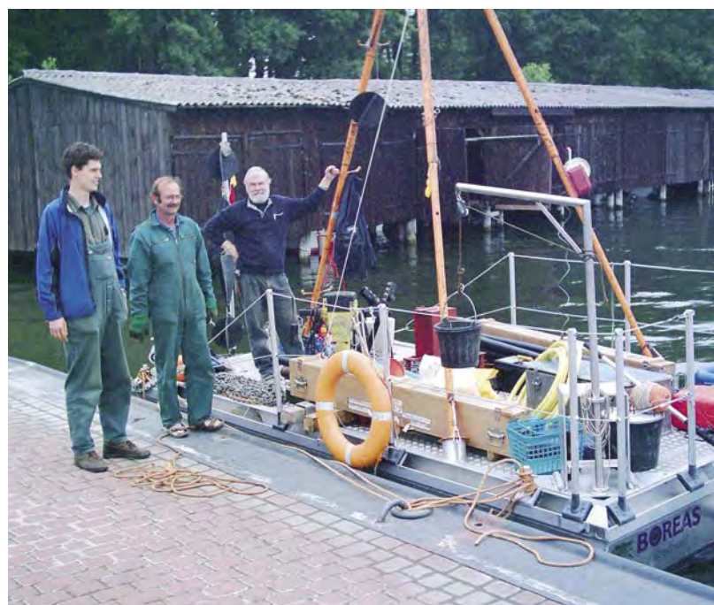
Abb. 10: Aufgerüstetes Ponton mit Dreibock zum Ziehen des Bohrgestänges (v.l.n.r. Dr. Sebastian Lorenz, Christian Wünsche und Dr. Hinrich Meyer; Foto: Jürgen Becker).
