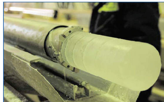
Abbildung 3: Ein Eiskern wird dem Kernrohr nach der Bohrung entnommen. Der Durchmesser des Kerns ist ca. 10 cm und hat eine Länge von ca. 1-2 m.
