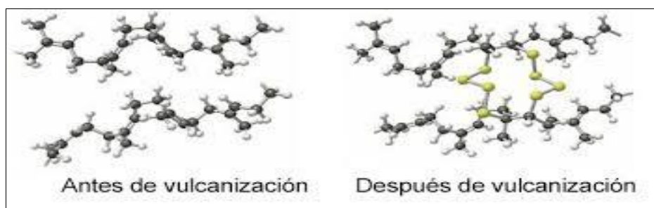
Figura 16. Estructura del caucho antes y después de la vulcanización
