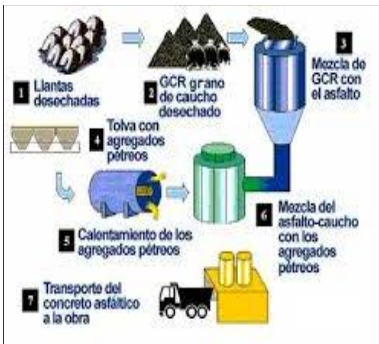
Figura 27. Proceso de adición de partículas de neumáticos usados al asfalto
