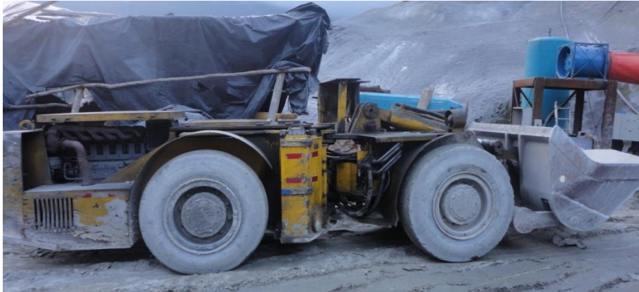
Foto 23, Maquina rezagadora “Scoop”.
