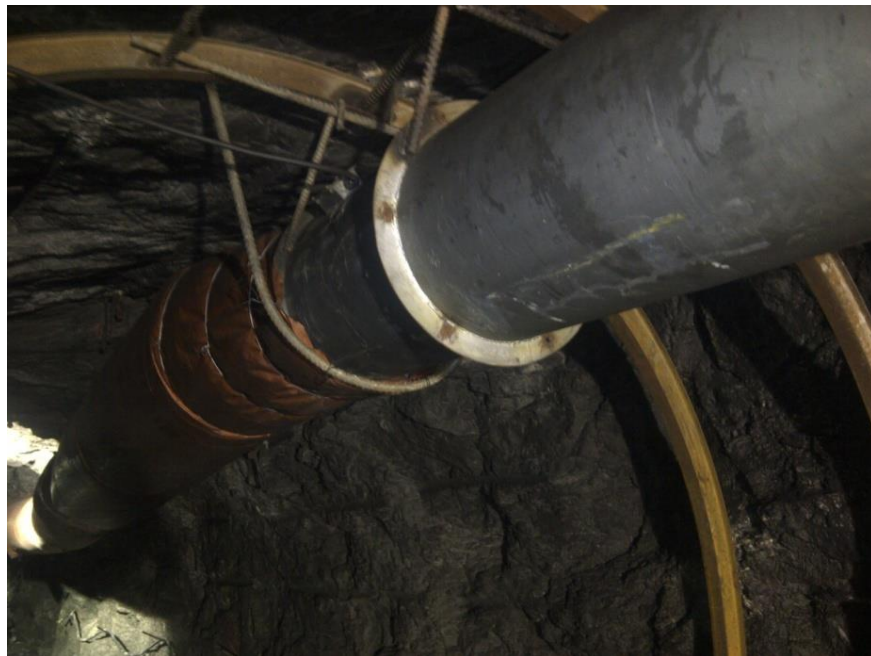
Foto 22, Acople con segundo ventilador 40 hp (Abscisa 0+750).
