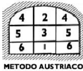
Gráfico 24, Construcción de túnel según Método Austriaco.
