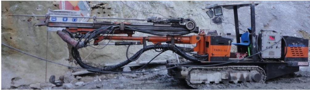
Foto 18, Equipo de perforación “Jumbo”
