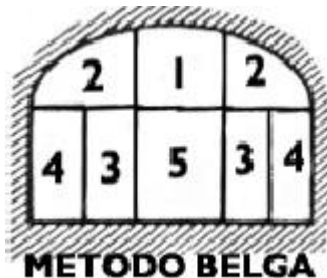
Gráfico 22, Construcción del túnel según Método Belga.
