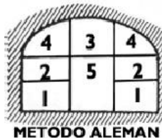
Gráfico 23, Construcción del túnel según Método Alemán.
