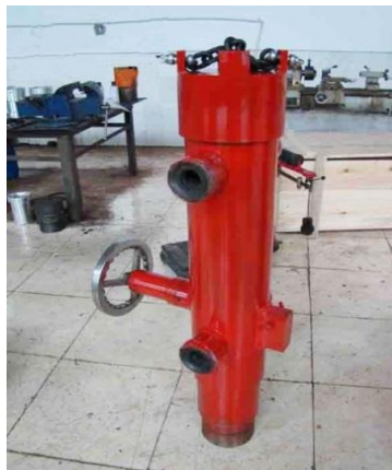
Figura 10.- Cabezal de Cementación
