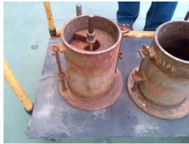
Fotografía N° 21. Pesas sobre la muestra compactada. autor
