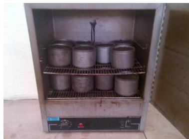
Fotografía N° 38. Curado de briquetas en el horno. Autor
