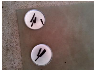
Fotografía N° 9. Bastones de suelo para determinación del LP. Autor
