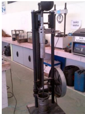
Fotografía N° 36. Elaboración de briqueta. Autor
