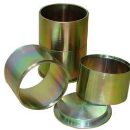
Gráfico N° 12. Molde metálico para compactar briquetas
