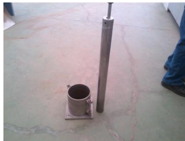
Fotografía N° 13. Equipo de compactación. Autor
