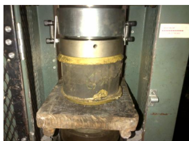
Fotografía Nº 31. Ensayo a compresión de la probeta suelo-cemento. Autor
