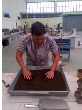
Fotografía N° 15. Homogenización del suelo humectado. Autor
