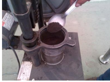
Fotografía N° 35. Colocación del suelo en el molde a compactar. Autor
