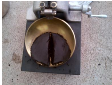
Fotografía N° 7. Surco de la muestra en la cápsula de Casagrande. Autor
