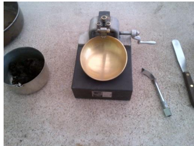
Fotografía N° 4. Equipo de Casagrande. Autor
