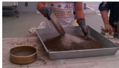
Fotografía N° 29. Incorporación del cemento. Autor
