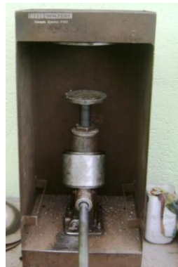
Fotografía N° 33. Equipo utilizado para la extracción de briquetas. Autor
