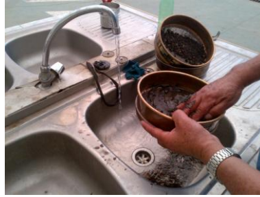
Fotografía N° 11. Lavado del material en el tamiz N° 200. Autor
