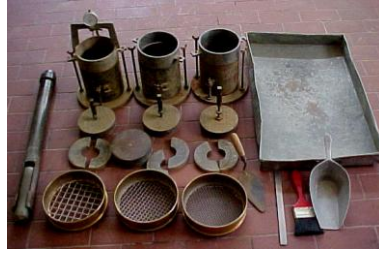
Fotografía N° 18. Equipo CBR. Autor
