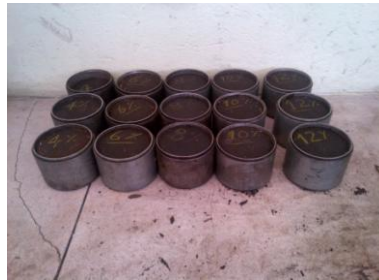
Fotografía N° 37. Muestra compactada dentro del molde. Autor
