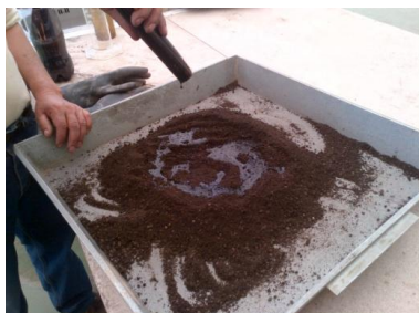
Fotografía N° 34. Mezcla del suelo con emulsión asfáltica. Autor
