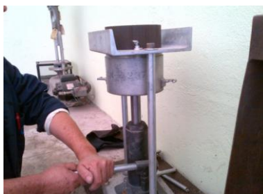
Fotografía N° 30. Extracción de la muestra suelo-cemento. Autor
