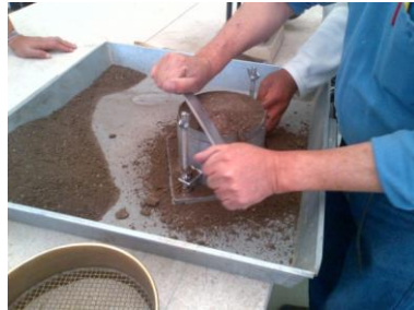
Fotografía N° 16. Enrasado del suelo compactado. Autor
