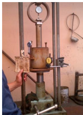
Fotografía N° 22. Ensayo del penetración CBR. Autor
