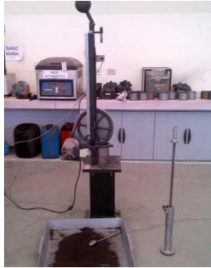
Fotografía N° 32. Equipo para la compactación de briquetas por el método Marshall. Autor
