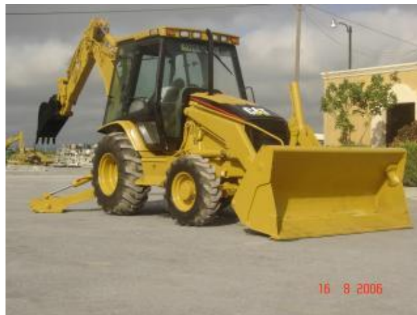
Figura 2. Equipo Multiuso (Transcavo).
