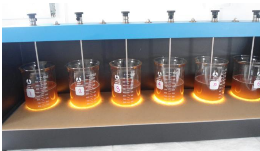
Figura 10. Equipo de prueba de Jarras
