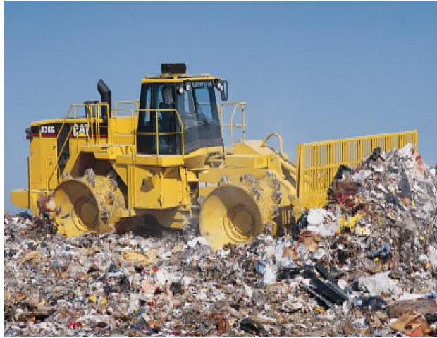
Figura 1. Compactador de Basura.
