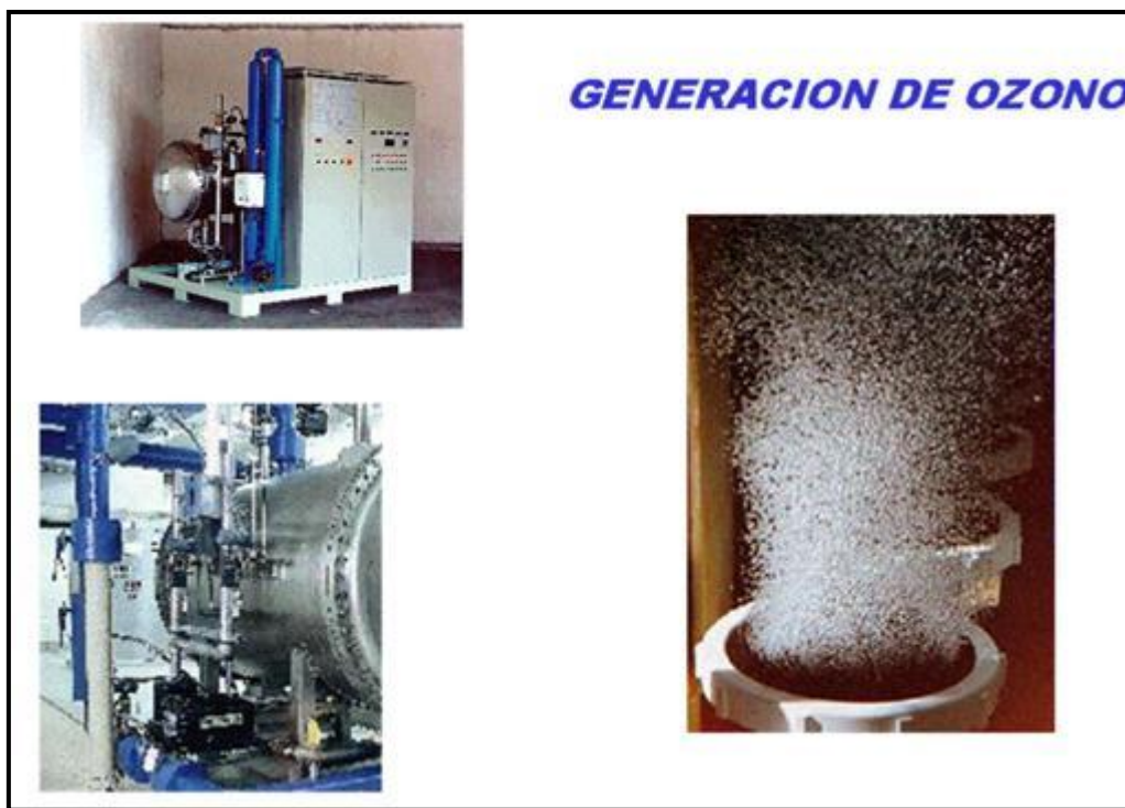
Figura 9. Equipo industrial para producción de ozono y difusores de burbuja fina para inyección del aire rico en ozono.
