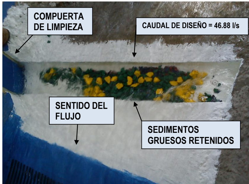
Fotografía 6.8. Sedimentos retenidos en el canal desripiador (tomado por Herrera Diego)
